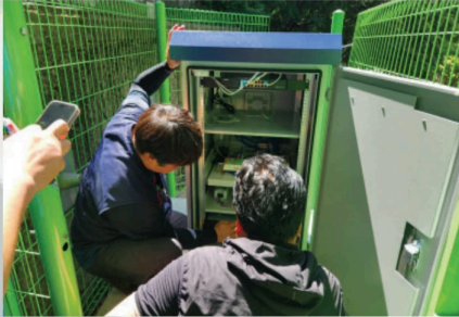
<전문가 현장자문을 통한 상시계측관리시스템 검수 및 시운전>
