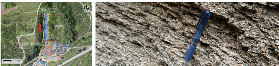
그림 3. 경북 문경시 산북면에서 발생한 산붕괴 및 붕괴면에서의 풍화에 의한 micro-sheeting(2023년 7월 26일)
