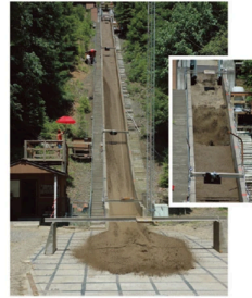
그림 5. 실 규모 토석류 시험 전경 (Iverson et al. 2011)
