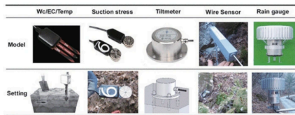
그림 2. 모니터링 센서의 설치개념
