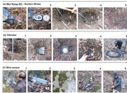
그림 3. 모니터링 센서의 설치방법
